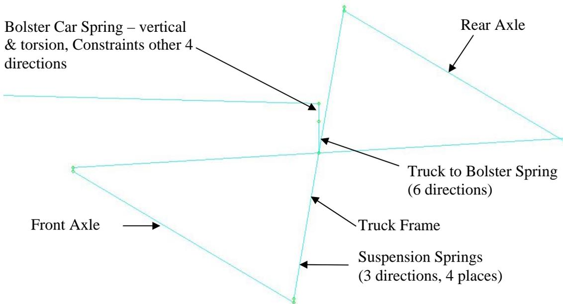
**Figure 3-4: Truck B Detail**
